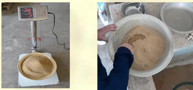
Imagen 9 Selección de 5kg de suelos - Preparación de muestra aumentando humedad
