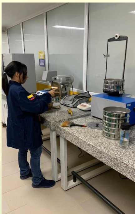
Imagen 8: Realización de granulometría
