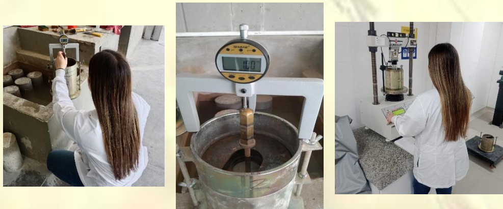
Imagen 11 Armado de CBR - Nivel antes de sumergir en agua - Fallando CBR
