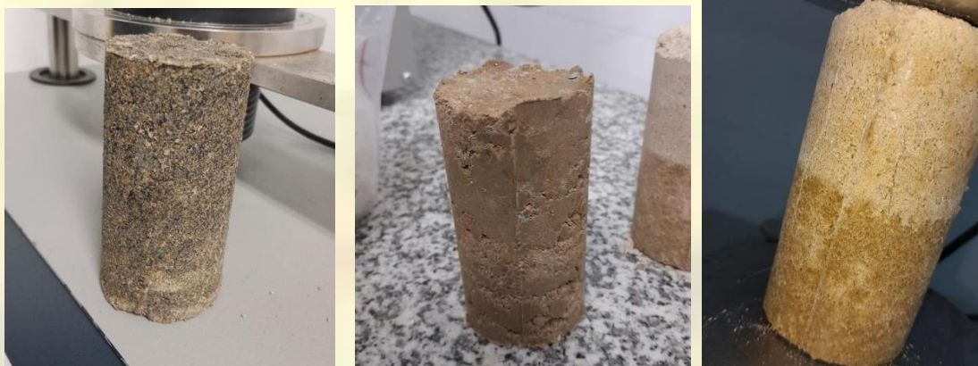
Imagen 12 Inconfinada con cascarilla de arroz caolinizada - cemento - cal
