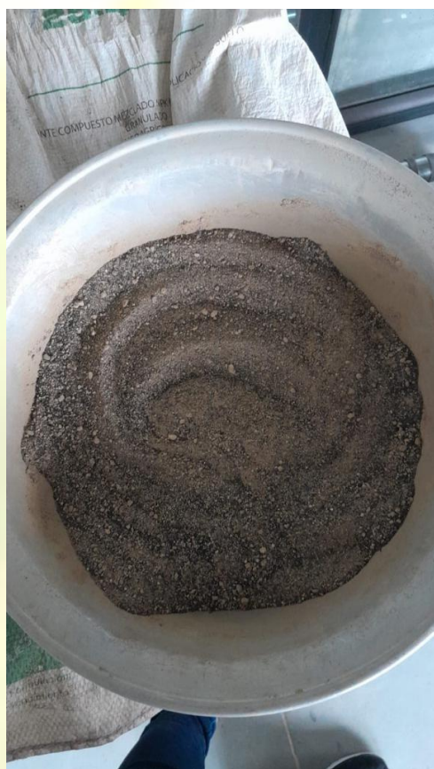
Imagen 4: Mezcla de suelos, de izquierda a derecha: cascarilla de arroz caolinizada, cemento y cal
