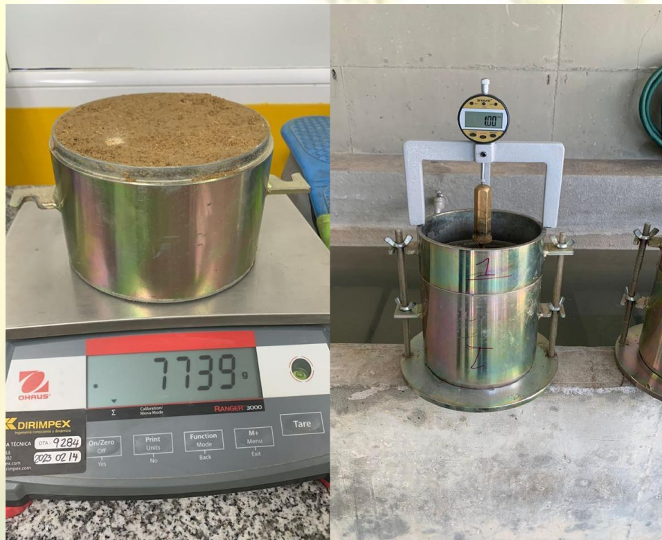
Imagen 6: Laboratorios de suelo (geotecnia) Proctor (izquierda) CBR (derecha)
